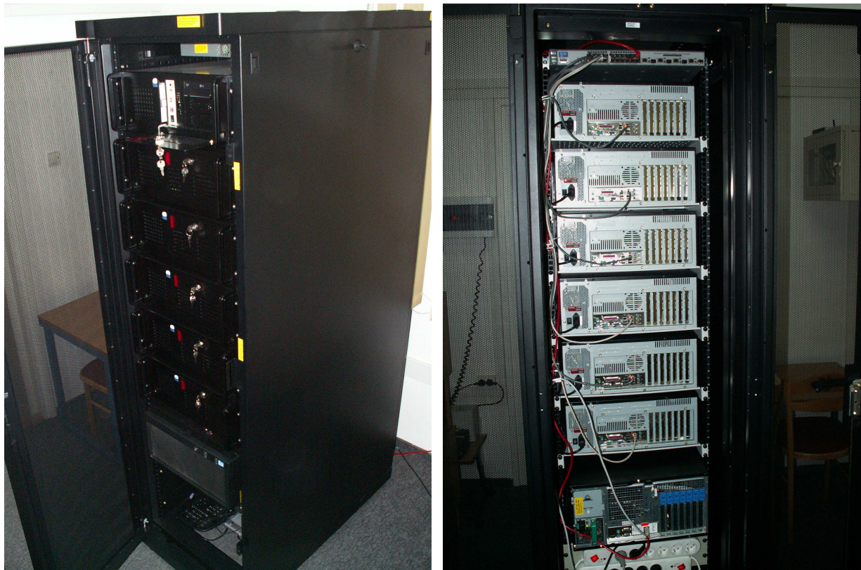
Rys. 6.7 Sprzętowa realizacja systemu IGA
